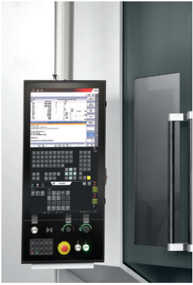
采用全新升级西门子 SINUMERIK ONE 数控系统显著提高生产率
