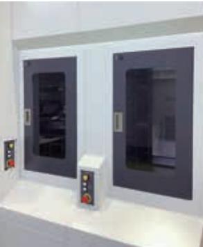
TMX-4000 可从后部进行工具交换， TMX-2000 可从正面进行工具交换。 (图片：80 ATC 规格)
